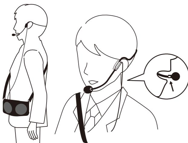
2. 側面にある端子カバーを開け、ヘッドマイクのプラグをマイク端子に接続します。
