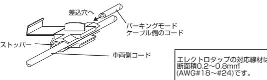
2. プライヤー等で金属端子を完全に押し込み、接続後にカバーを倒しロックします。
