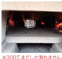
中板の上に置いて窯内の温度を測ります。針が振り切れたら取り出してください。その後さらに炭を足すとピザが焼けるような温度になります。
