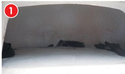
石窯の奥と左右の隙間(3カ所)に炭を置きます。いきなり大きな炭を入れずに、小さな炭からスタートしてください。
