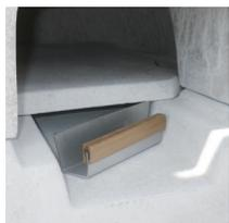
開口部の下段に使用。プレートで空気が入る隙間を調整する事で火力を加減します。パン・ケーキなど低温料理に便利!
