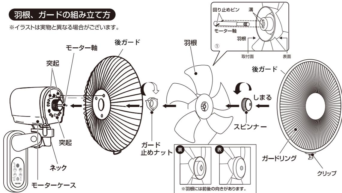
1. 後ガードをモーターケースの突起に合わせて入れ、ガード止めナットで固定します。
