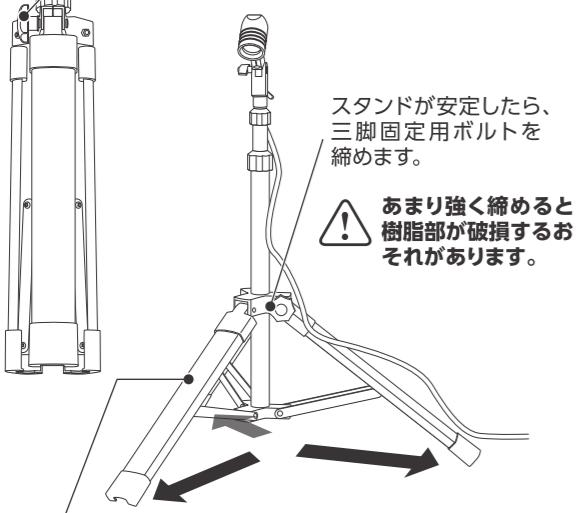
収納時支柱より上の脚部を持ち上げると同時に本体を押し下げながら三脚を折りたたんでください。
