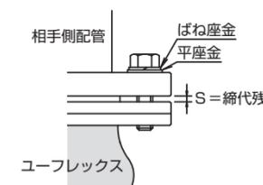
●フッ素樹脂製フレキシブル継手は材質特性上、シール性が低下する可能性があります。（温度変化が著しい場合）この場合には増締めを行うか、ガスケットをご使用ください。なお、ユーフレックスの200A~300Aについては、付属のガスケットを使用して取付けてください。
