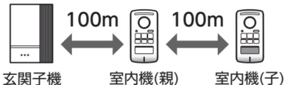
ただし、最大距離ですので取り付ける前に必ず、その場所ですべての室内機と玄関子機および室内機間で呼び出し・通話ができることを確認してください。取付環境により通話可能距離が短くなる場合があります。
