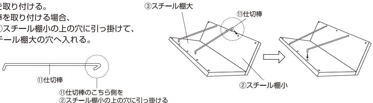
4 組み立てた後、ガタツキがあったり棚がうまく取り付けできない場合は、ネジ（サイド板部）を少しゆるめて本体調整後に再度締め直して下さい。
