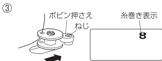
③ ボビンを、ボビン押さえの方に押しつけます。表示画面に糸巻き位置にセットされたことを示す糸巻き表示が点灯します。
