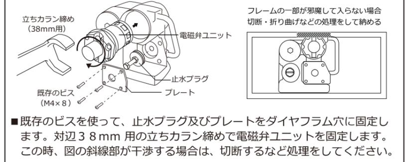
■ 既存のビスを使って、止水プラグ及びプレートをダイヤフラム穴に固定します。対辺 3.8mm 用の立ちカラン締めで電磁弁ユニットを固定します。この時、図の斜線部が干渉する場合は、切断するなど処理をしてください。
