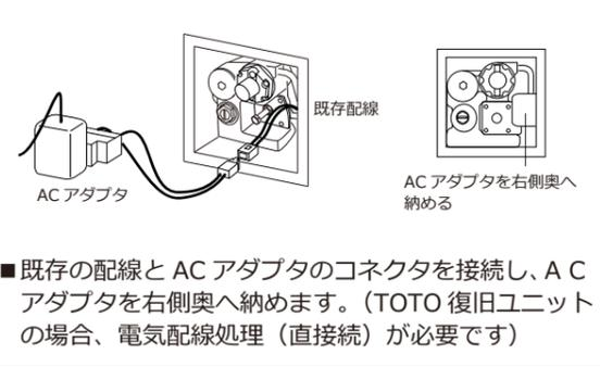
■ 既存の配線と AC アダプタのコネクタを接続し、AC アダプタを右側奥へ納めます。（TOTO 復旧ユニットの場合、電気配線処理（直接続）が必要です）
