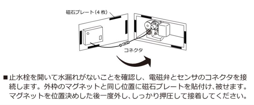
■ 止水栓を開いて水漏れがないことを確認し、電磁弁とセンサのコネクタを接続します。外枠のマグネットと同じ位置に磁石プレートを貼付け、被せます。マグネットを位置決めした後一度外し、しっかり押圧して接着してください。
