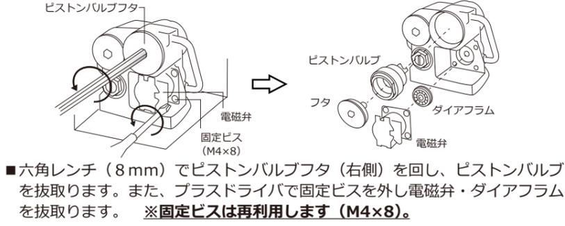
■ 六角レンチ（8mm）でピストンバルブフタ（右側）を回し、ピストンバルブを取ります。また、プラスドライバーで固定ビスを外し電磁弁・ダイヤフラムを取ります。 ※固定ビスは再利用します（M4×8）。
