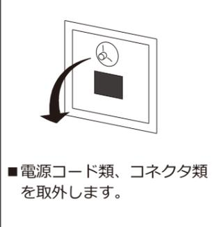
■ 電源コード類、コネクタ類を取外します。
