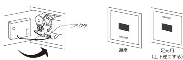
■ 止水栓を開いて水漏れがないことを確認し、電磁弁とセンサのコネクタを接続してセンサユニットを被せます。足元用としてご使用の場合は、センサ距離を 100cm に変更し、上下逆に被せてください。
