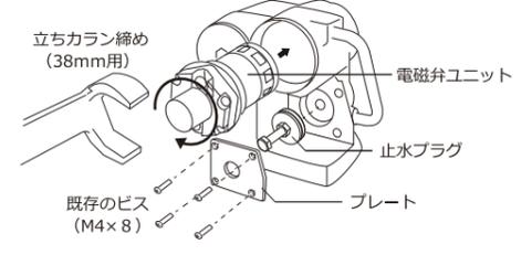
■ 既存のビスを使って、止水プラグ及びプレートをダイヤフラム穴に固定します。また対辺 3.8mm 用の立ちカラン締めで電磁弁ユニットを固定します。
