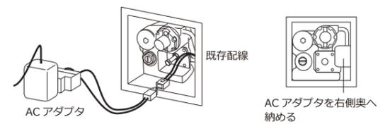
■ 既存の配線と AC アダプタのコネクタを接続し、AC アダプタを右側奥へ納めます。（TOTO 復旧ユニットの場合、電気配線処理（直接接続）が必要です）
