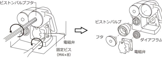
■ 六角レンチ（8mm）でピストンバルブフタ（右側）を回し、ピストンバルブを抜取ります。また、プラスドライバーで固定ビスを外し電磁弁・ダイヤフラムを抜取ります。 ※固定ビスは再利用します（M4×8）。
