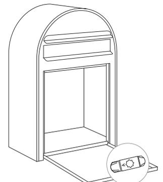
6 ダイヤル錠を取り付けたら、扉を閉めて施錠・解錠の確認をします。
