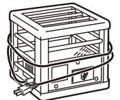
●電源コードが破損し、火災・感電の原因になります。
