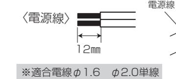
\*適合電線  $\phi 1.6 \phi 2.0$  単線
