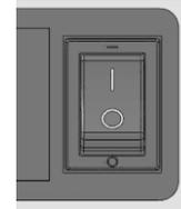
2. [MAIN POWER]表示ランプが点灯し、[7セグメントディスプレイ]に圧力(0.0kPa)と表示されていることを確認します。
