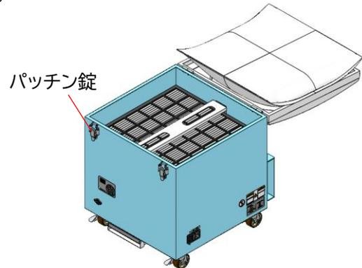
2. 2次フィルター固定金具を引っ張って外し、2次フィルターを取り外します。
