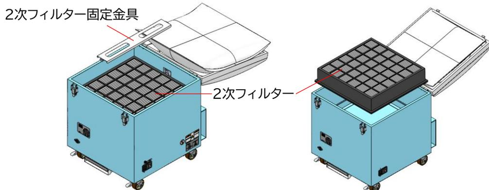
3. 新しい2次フィルターを取り付け、2次フィルター固定金具を押し込んで付けます。
