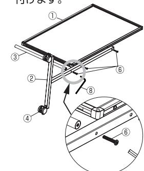
3 反対側の②支柱も「手順2」と同様に③横バーと①ボードを⑥六角穴ボルトで取り付け⑧六角レンチで締め付けます。
