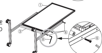
4 [図1]:①ボード下に⑤トレイを斜めに配置します。
