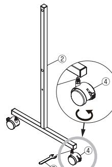
2 ④キャスターを取り付けた②支柱の片側に③横バーと①ボードを⑥六角穴ボルトで取り付け⑧六角レンチで締め付けます。
