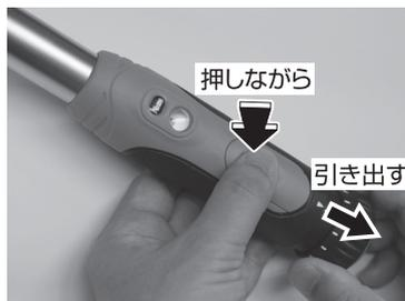
2 トルク調整リングを回して、スクリーン内の数値を確認しながら、設定したいトルク値に調整します。
