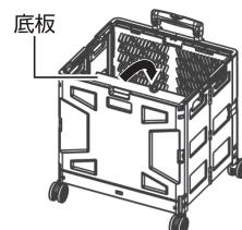
4. 両側の側板スライドロックをスライドさせて、側板を固定させます。
