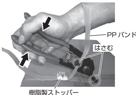
4. 引締め作業後、内蔵カッターで余分なPPバンドを切断する。
