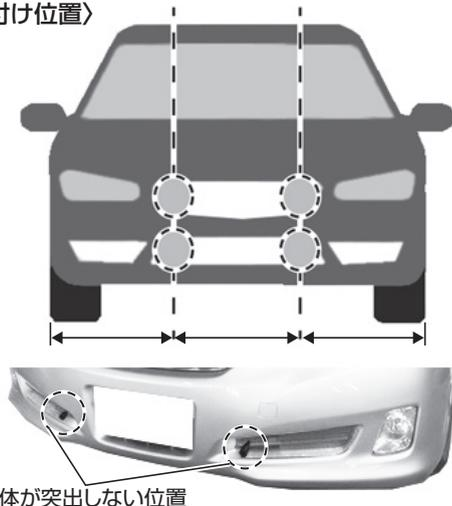
※ 車種のバンパー形状によって、バンパーに取り付けることが困難な場合は本体が車体から突出しない位置で走行中に風が笛を通り抜けやすい位置に取り付けてください。
