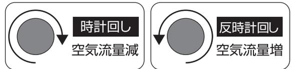
③ パターン調節ツマミを回してパターン形状を調節します。
