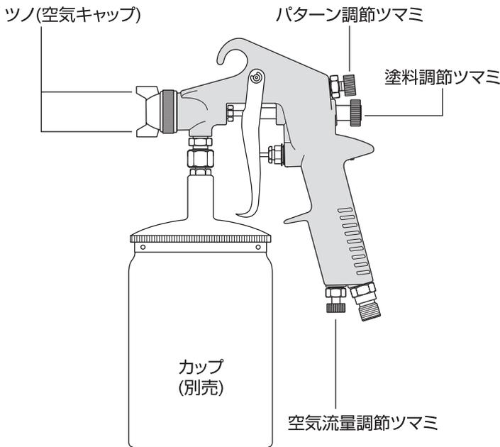
① 塗料調節ツマミを回して塗料量を調節します。
