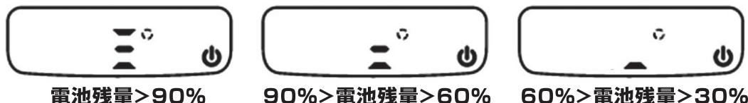
※ふたが開かない場合や、電池残量表示が1と表示された場合は、電池の取付け方法をご確認の上、電池交換してください。
