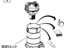
固定ロックを外し、ハウジングを開けてください。キャストと付属品が入っていますので取り出してください。
