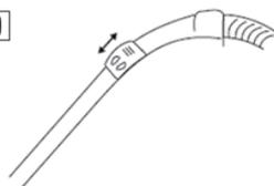
吸入量調整部を上下に動かして、風量を調整してください。
