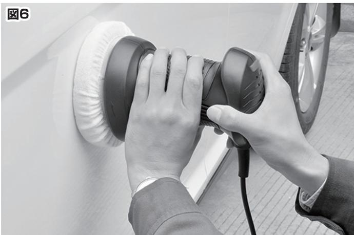
6. 次にドアなどの表面で作業をしてください。垂直面上で作業をする時は、常に電源コードを肩にかけるか、地面に垂らし、可動する研磨ヘッドから電源コードを十分離してください。(図6参照)
