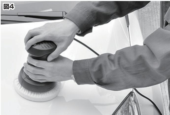
4. 常に作業対象物(車等)の表面または作業対象物(車等)に接して電動ポリッシャーを始動し停止してください。(図4参照)
