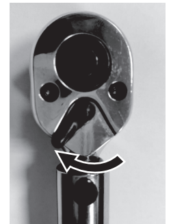
左ねじを締め付ける (逆回転で締め付ける)
