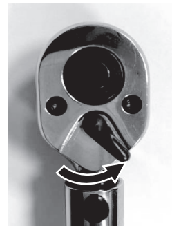
右ねじを締め付ける (正回転で締め付ける)
