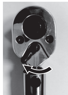
左ねじを締め付ける (逆回転で締め付ける)
