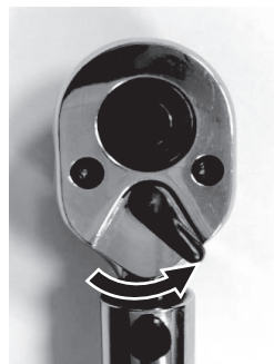
右ねじを締め付ける (正回転で締め付ける)
