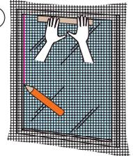
③ 定規などで、ガラス面の枠いっぱいまで押さえ、ペンで印(枠線)を描きます。
