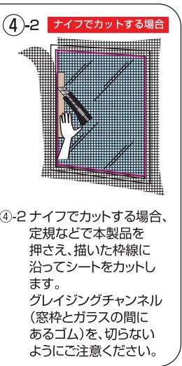
④-2 ナイフでカットする場合、定規などで本製品を押さえ、描いた枠線に沿ってシートをカットします。グレイジングチャンネル(窓枠とガラスの間にあるゴム)を、切らないようにご注意ください。
