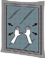
② 本製品を窓枠まで覆うように、ガラス面に密着させ、手で中央から四方に向かって押さえ、本製品のシワを伸ばします。メッシュ部分から空気が抜けるため、簡単にシワが直ります。
