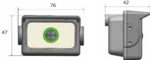
・カメラ設置ブラケット寸法(mm)
