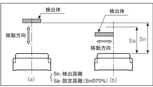
● 検出体の形状、サイズ、材質によって検出距離が変化します。そのため左図(a)のように検出距離を確認した後、左図(b)のように検出体を設定距離(Sa)以内で通過して下さい。
