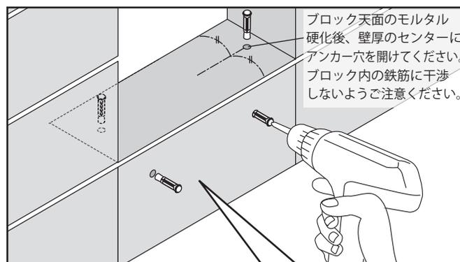
② コンクリートに下穴を開け、オールプラグボルトを取り付けます。(4ヶ所)
