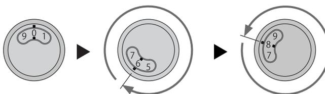
右へ2回転以上回してから 6で止め、 左へ回して 8で止める
