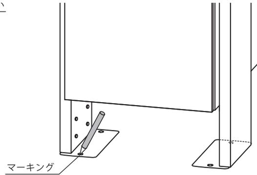
⑥ コンクリートにアンカー用の下穴(φ14mm深さ45mm)を開け、
