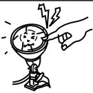
電源回線は、電動機・工作機などの動力系およびHID安定器などは必ず異なるコンセントで、本製品専用としてご使用ください。
