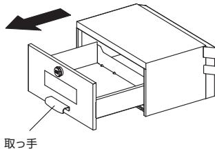
ダイヤル錠を解除し、取出口ボックスを手前に引き出して開けてください。
