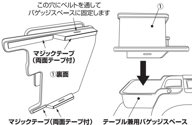
**2** ②・③を下図のように裏面に付属されている両面テープでセンター コンソール及びサブコンソールの上蓋に貼り付けます。
