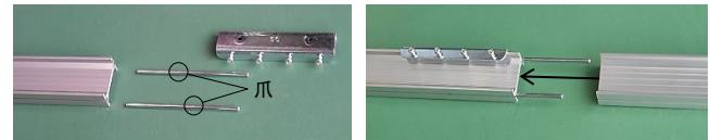
③もう一方のレールを差し込み、継ぎ目部にTOPカバーの中央がくるようスライドさせビスを締め固定します。
