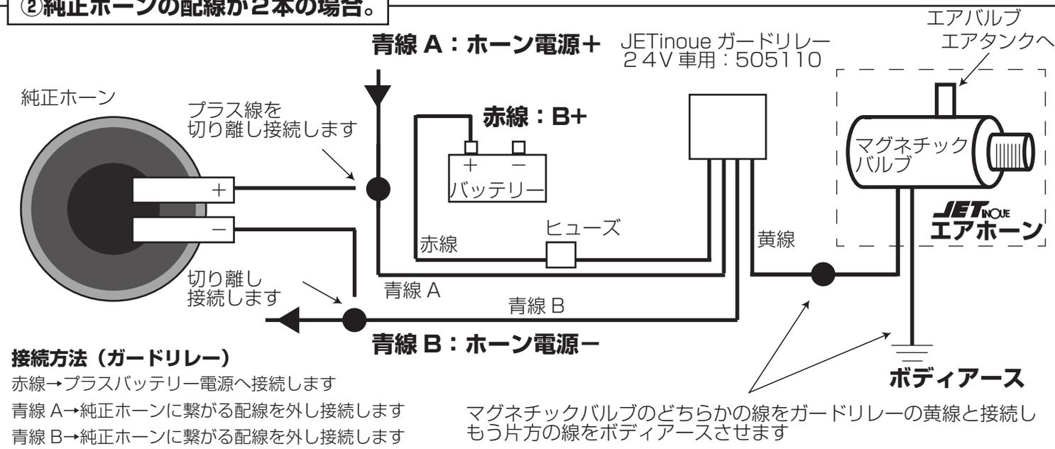
\* ガードリレー赤線と接続するバッテリー電源のあいだに、使用するホーンの消費電流に応じて付属のヒューズを選択してご利用ください。
