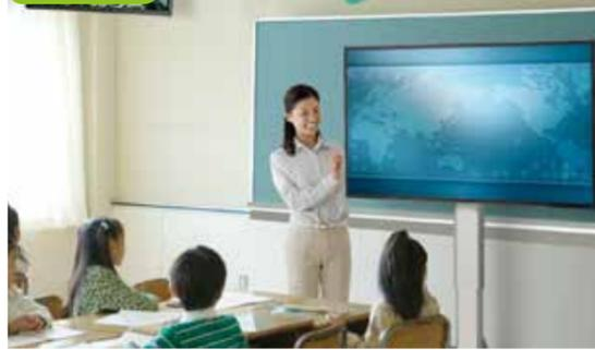
電子黒板の画面をタッチしてもディスプレイが揺れない強化支柱構造
