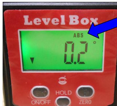
「ABS」の文字が表示され、水平面よりどれだけ傾いているかが表示されます。「ABS」表示中は水平からの角度を表示します。
