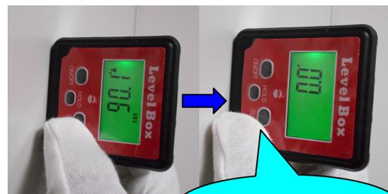
ZEROボタンを押すと、表示角度がゼロになり、現在の角度が測定基準にセットされます。
