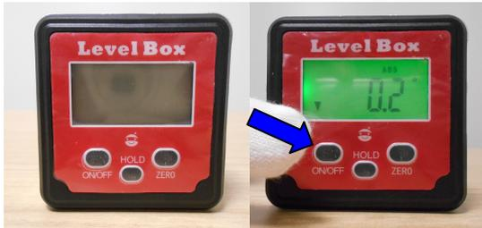
平らな水平面に測定面を下にして本製品を置き、ON/OFFボタンを押して電源を入れます。
