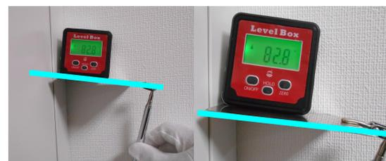
角度を測りたい場所に本製品を設置すると手順④でセットした測定基準からの角度が表示されます。
