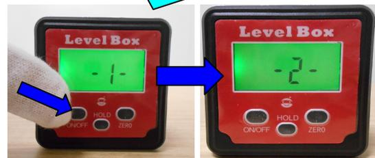
ON/OFFボタンを押すと、液晶画面の「-1-」が点滅し、しばらくすると「-2-」に変わります。
