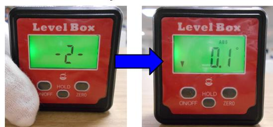
液晶画面の「-2-」が点滅し、しばらくすると通常の角度表示に戻ります。校正完了です。
