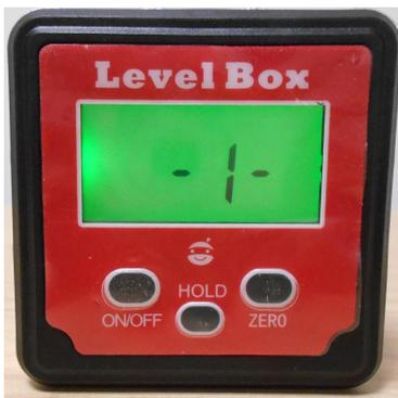
液晶画面に「-1-」と表示され、本製品が再調整モードに入ります。
