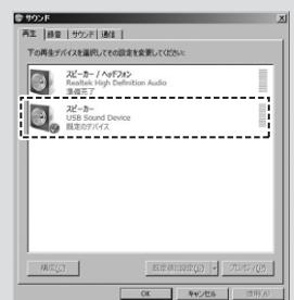
起動音や警告音はUSBスピーカーから出ますが、特定の再生ソフトからの音声が出ない場合、再生ソフトの音声出力設定が[USB Sound Device]になっているかご確認ください。
