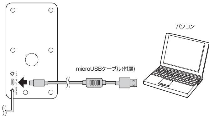
(2)「電源・入力切替ボタン」を押してUSB接続モード(LED:水色)に切り替えてください。
