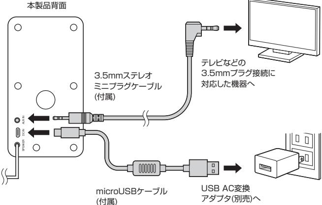
(3)「電源・入力切替ボタン」を押して3.5mmプラグ接続モード(LED:緑色)に切り替えてください。
