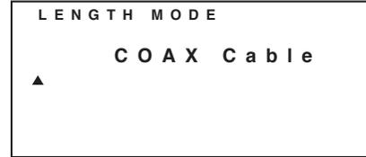
「LENGTH」ボタンまたは「TEST」ボタンを押すと計測を開始します。
