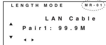
■「MEMORY」ボタンを3秒間以上長押しすると、保存した計測結果を表示します。「▲」「▼」ボタンでメモリ番号を変更できます。モードボタンのいずれかを押すと、メモリ表示を終了します。
