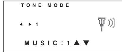
「◀」「▶」ボタンを押すと、信号を出力するペアを選択できます。「▲」「▼」ボタンを押すと、出力する信号の周波数を変更できます。(2種類の周波数から選択)
