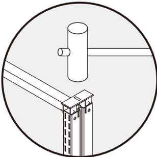
キャップの突起部が支柱の丸穴にはまる様に確実にハンマーで叩いてください。
