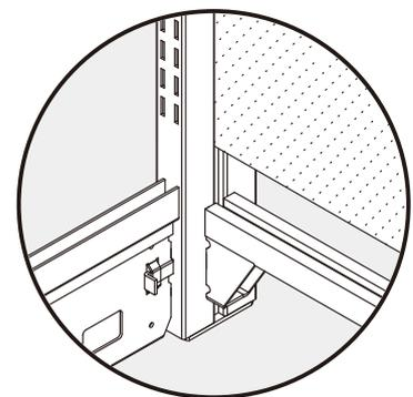
パネルは支柱の溝・ボトムチャンネルの溝に確実に入れてください。
