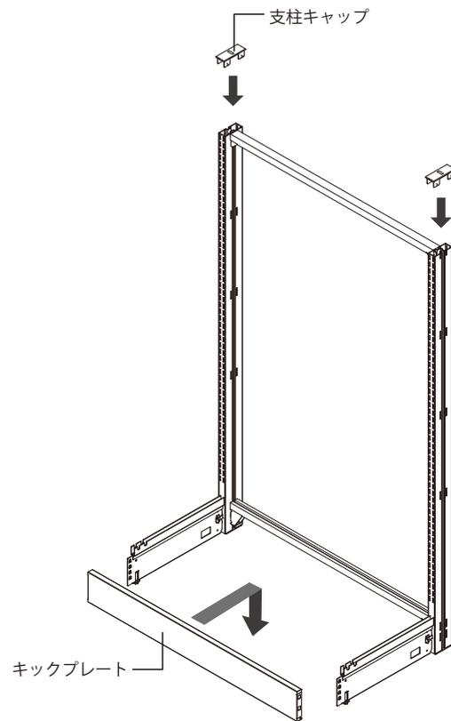
※エンドフレームを取り付ける場合はエンドフレームを取り付けた後に支柱キャップを取り付けてください。
