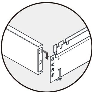
キックプレートの両端の穴をベース先端側面の爪に合わせるように取り付けてください。
