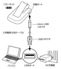
充電用USBケーブルをカーキットの充電ポートとパソコンやAC充電器のUSBポ ートに接続します。充電中はLEDが赤く点灯し、消灯したら充電完了です。
